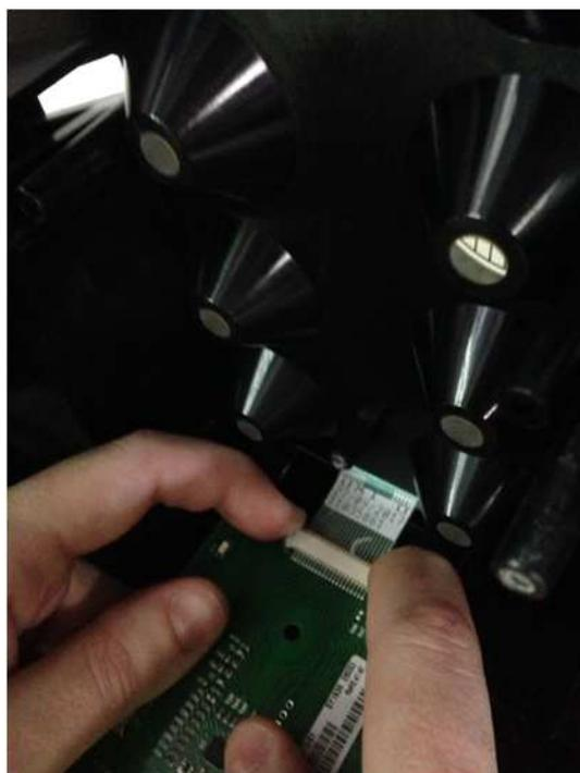
9 – Instalar de volta as placas na maquina se atentando ao cabo cinza que vem da power que vai no conector JP20 (“Power”) pois também encaixa no JP17 (“Keyboard”) mas não é neste lugar.
