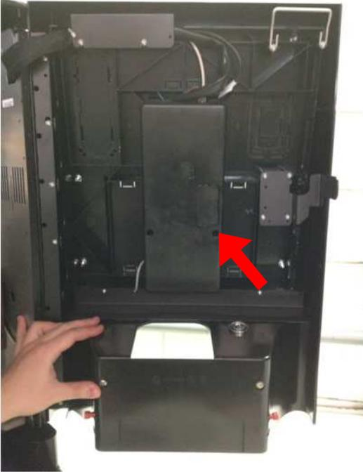
1 - Remover o parafuso Philips para remover a proteção da placa.
